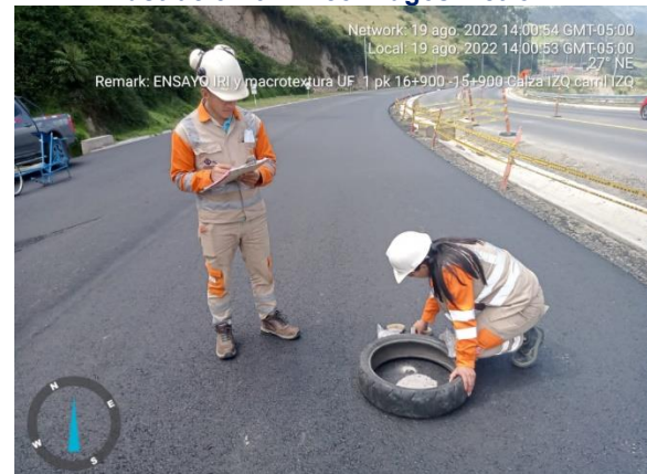
Ilustración 6. IRI con rugosímetro
